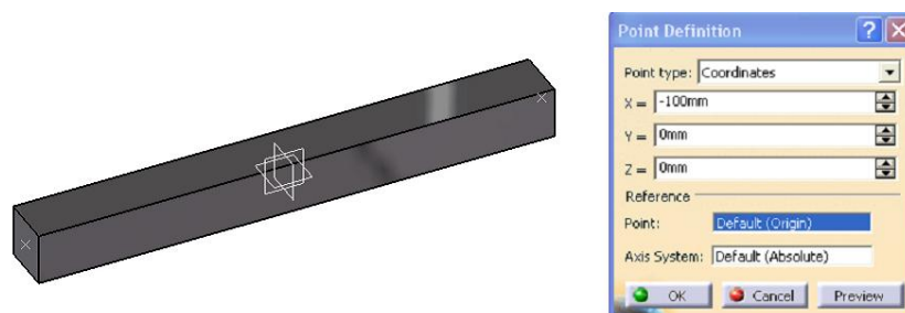
Slika 2. Postavljanje tačka na početku i kraju srednje linije grede
